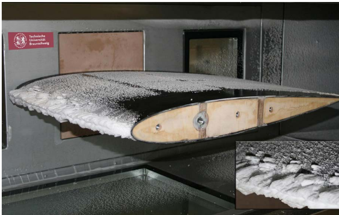
Abb. 1 Flügelprofil im Vereisungswindkanal nach Exposition mit unterkühlten Wassertropfen (Abdruck mit freundlicher Genehmigung des Instituts für Strömungsmechanik der TU Braunschweig)
